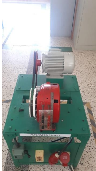
Gambar 4.6. Generator 1 (Prime mover AC motor) (Sumber: Dokumen pribadi)
