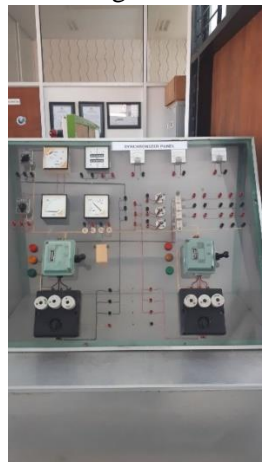
Gambar 4.13. Panel Sinkronisasi (Sumber: Dokumen pribadi)
