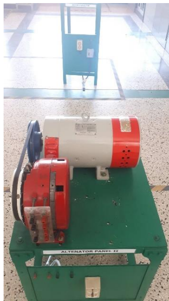
Gambar 4.7. Generator 2 (Prime mover DC motor) (Sumber: Dokumen pribadi)
