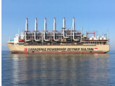
Gambar 1.2. Pembangkit Listrik Terapung Bentuk Kapal “Zeynep Sutan” Sumber : http://www.karpowership.com/
