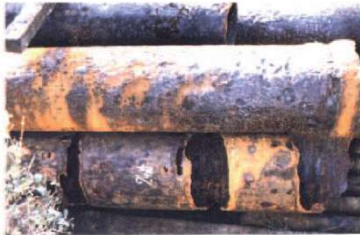
Gambar 2. 6. Contoh Permasalahan Underdeposit Corrosion pada Pipa (Andritsos, dkk, 2014)
