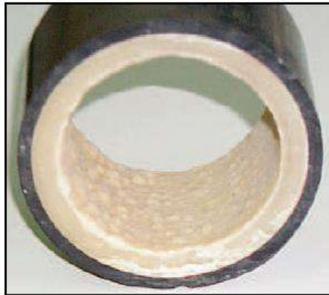
Gambar 2. 5. Contoh Permasalahan Scaling pada Pipa Akibat \text{CaCO}_3 (Andritsos, dkk, 2014)
