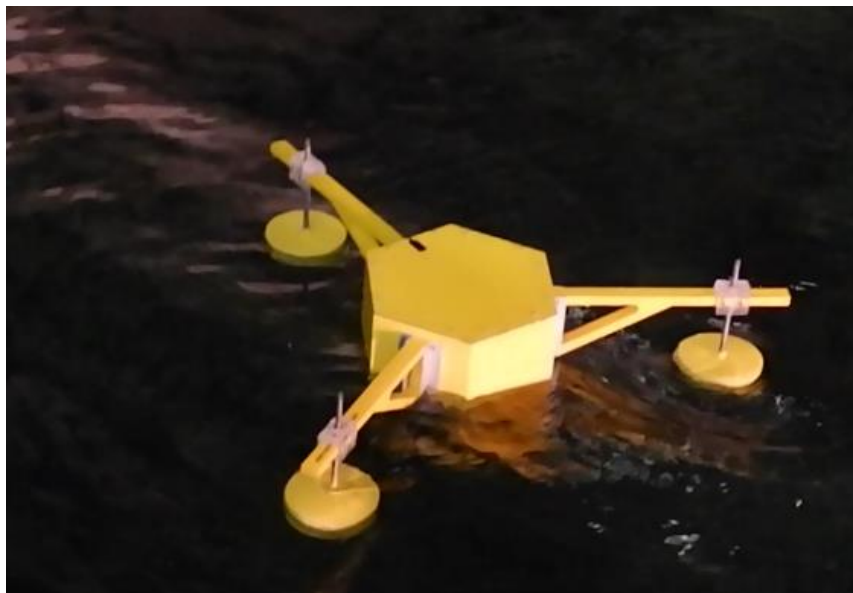
Gambar 41. Letak floaters dan kondisi pontoon saat pengujian variasi B
