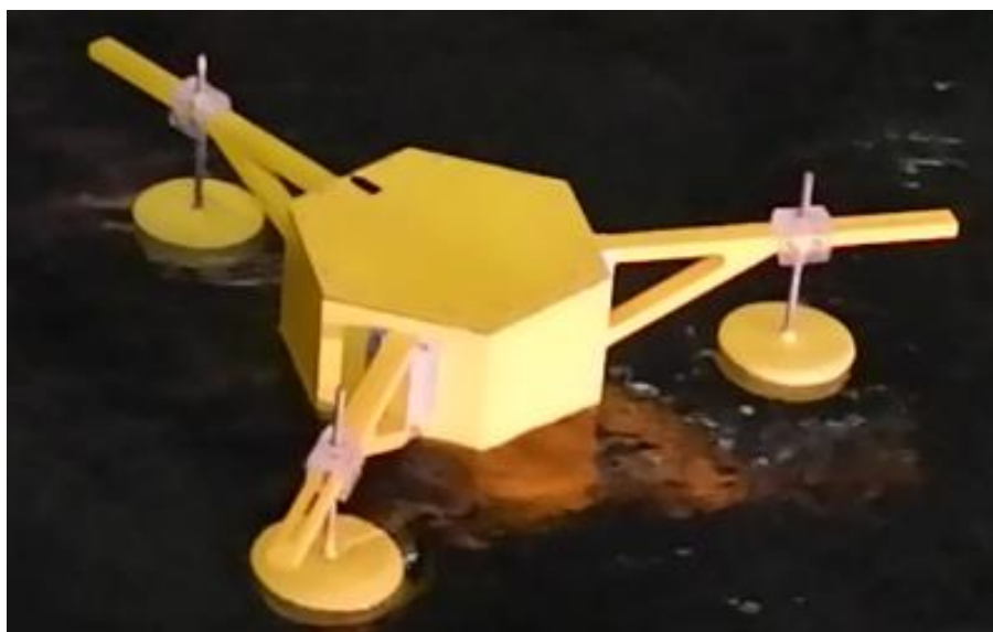
Gambar 36. Letak floaters dan kondisi pontoon saat pengujian variasi A
