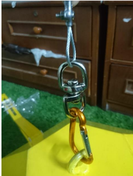
Gambar 13. Tambat yang terpasang di eye bolt pontoon
