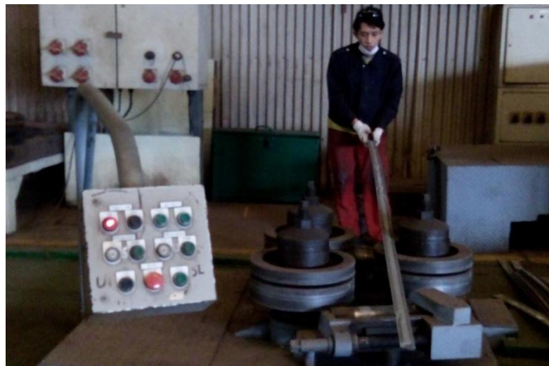
Gambar 4.4 Pekerja Menggunakan APD Secara Tidak Benar.
