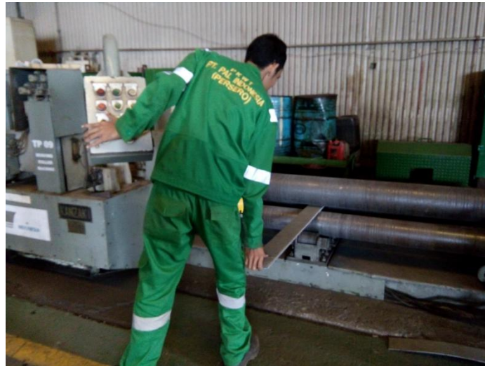
Gambar 4.3 Kondisi Pekerja saat Membentuk Plat Menggunakan Mesin.
