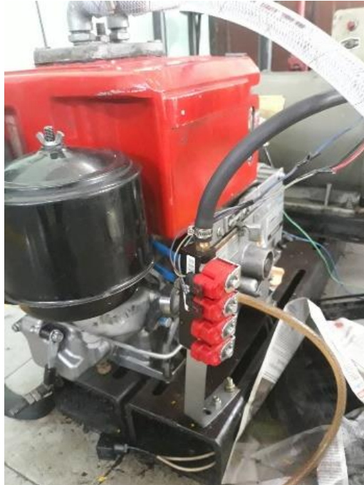
Gambar 3.6 Pemasangan Gas Injector Manifold pada Intake Cleaner
