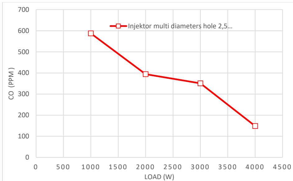
Gambar 4. 8 Grafik Hasil Emisi CO dengan Variasi diameter injektor 2.5 mm pada rpm 2000 dengan Variasi beban
