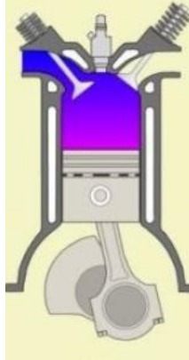
Gambar 2. 1 Langkah Hisap dan Injeksi Gas Pada Mesin Diesel Dual Fuel 4 Tak
