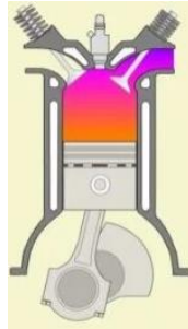
Gambar 2. 4 Langkah Hisap Pada Mesin Diesel Dual Fuel 4 Tak
