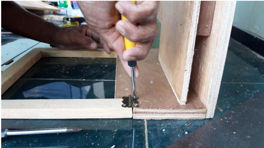
Gambar 4. 18 Proses pemasangan engsel
