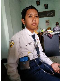
Gambar 3.11 Pemasangan alat sampling
