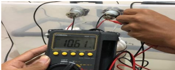
Gambar 4.10 Pengukuran Tegangan Pompa Peristaltik
