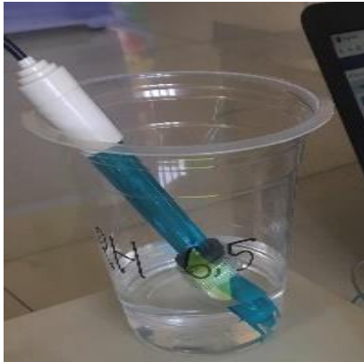
Gambar 4.5 Pengukuran Sensor pH Meter SKU:SEN0161
