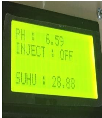
Gambar 4.7 Tampilan Output Pengukuran pada LCD 20x4
