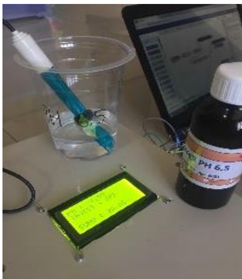
Gambar 4.4 Pengukuran Sensor pH Meter Secara Keseluruhan
