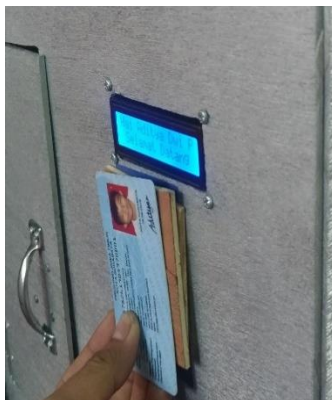
Gambar 4. 19 Uji Coba Pembacaan E-KTP Dengan Sensor RFID Reader Dengan Penghalang 12mm
