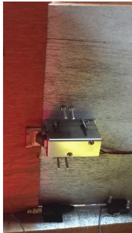
Gambar 4. 60 Solenoid Off Otomatis Setelah 5 Detik
