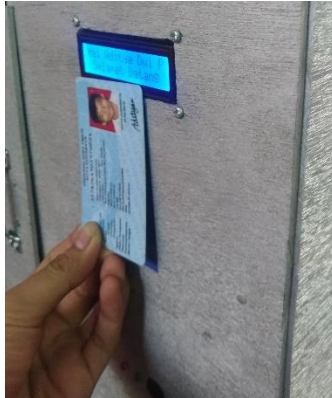
Gambar 4. 17 Uji Coba Pembacaan E-KTP Dengan Sensor RFID Reader Dengan Penghalang 4mm
