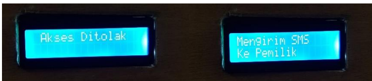
Gambar 4. 34 LCD Menampilkan Karakter Saat Kartu Tidak Terdaftar
