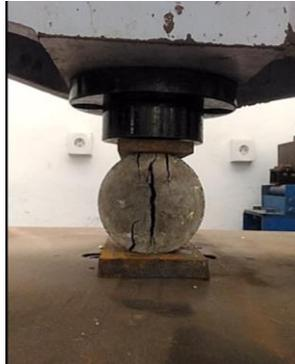
**Gambar 3. 10** Uji Tarik belah beton
