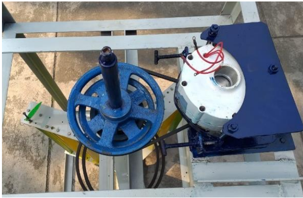
Gambar 3.6 Sistem transmisi belt and pulley dengan rasio 1:5.
