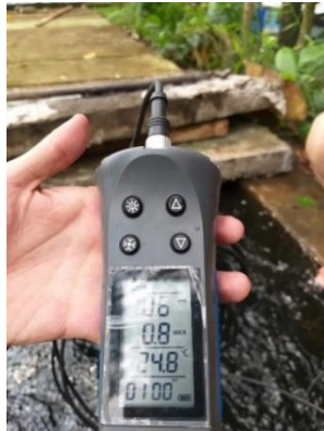
Gambar 3.11 Current meter yang digunakan
