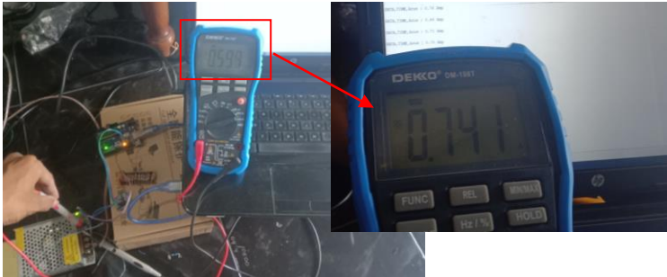
Dokumentasi Pengujian dan Kalibrasi Sensor Arus(INA219)
