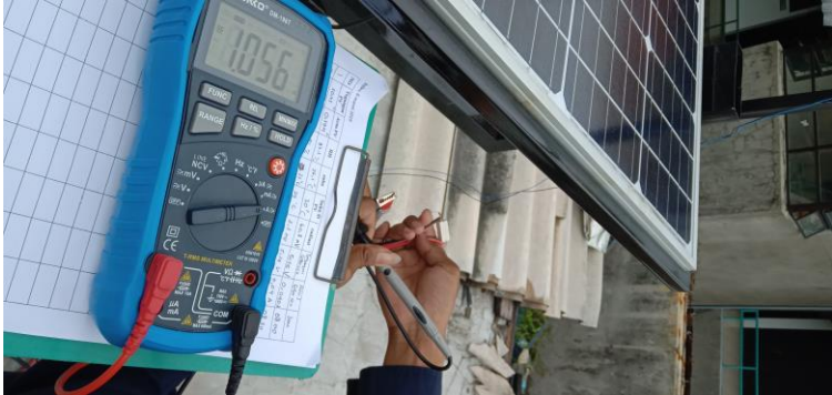
Dokumentasi Pengujian arus keluaran panel surya
