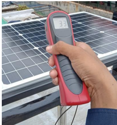
Dokumentasi Pengujian suhu di panel surya
