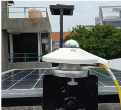
Dokumentasi Pengujian irradiance di sekitar panel surya
