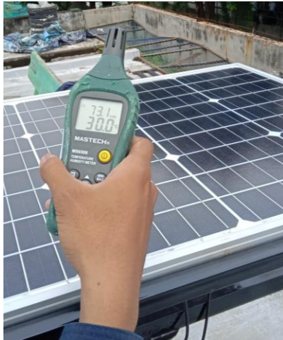
Dokumentasi Pengujian suhu dan kelembapan lingkungan panel surya
