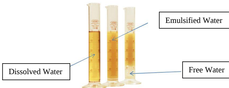
Gambar 2.1 Perbedaan Kontaminasi Air Dalam Oli[3]
