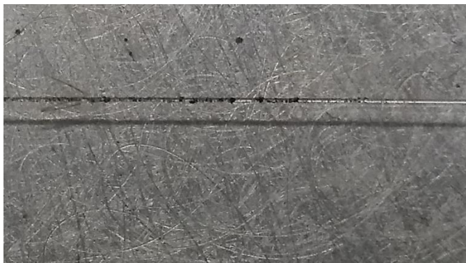
Gambar 4. 1 Hasil Pelapisan Graphene pada Sensor SMS
