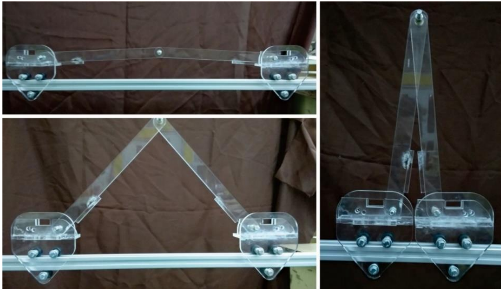
Gambar 5. 23 percobaan pelipat kain pertama (Sumber: Data Pribadi)
