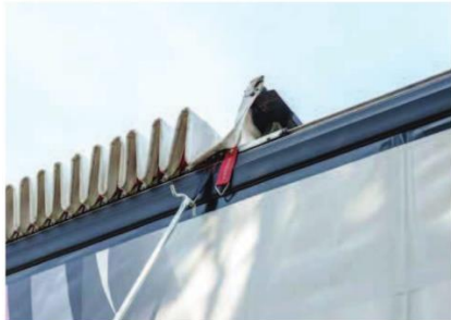
Lampiran 8 proses membuka omega cargo sliding roof dari luar truck Sumber: (Versus-Omega, 2019)
