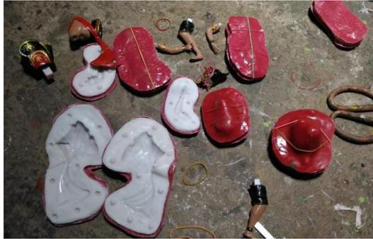
*Gambar 5. 30 Proses pembuatan molding atau cetakan
