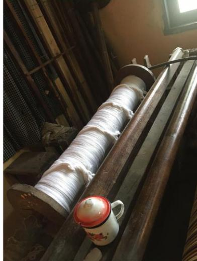
Deskripsi : Setelah proses hani, benang yang sudah dikumpulkan ditaruh dalam bim dan memasuki proses penggulungan. Disini benang yang disatukan sudah siap untuk memasuki tahap awal tenun
