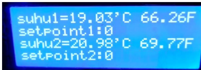
Gambar 4.10. Merupakan Gambar Penampilan 2 Sensor Suhu LM35 pada LCD
