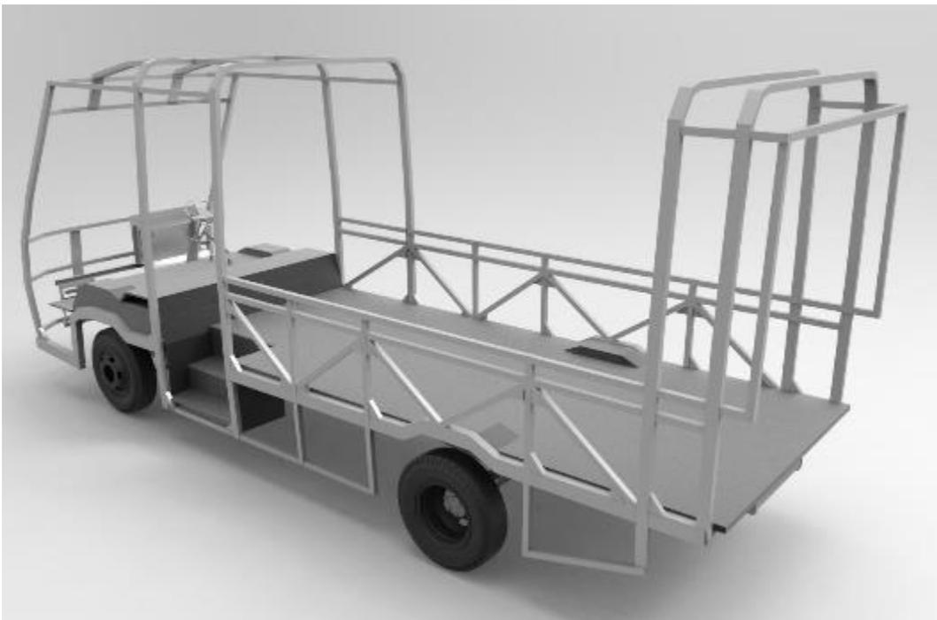
*Gambar 5. 18 Pemasangan Panel Flooring Pada Rangka Yang Sudah Terpasang Pada Sasis (penulis,2019)*
