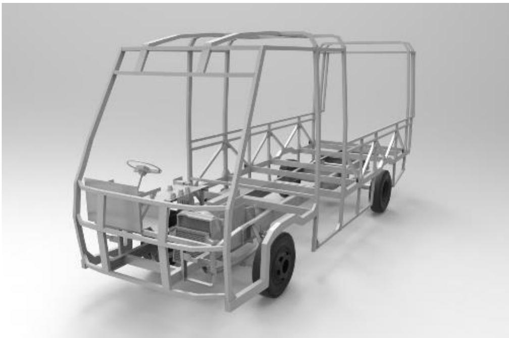
*Gambar 5. 16 Pemasangan Frame Body Depan Pada Sasis Mitsubishi Fe 73 (penulis,2019)*
