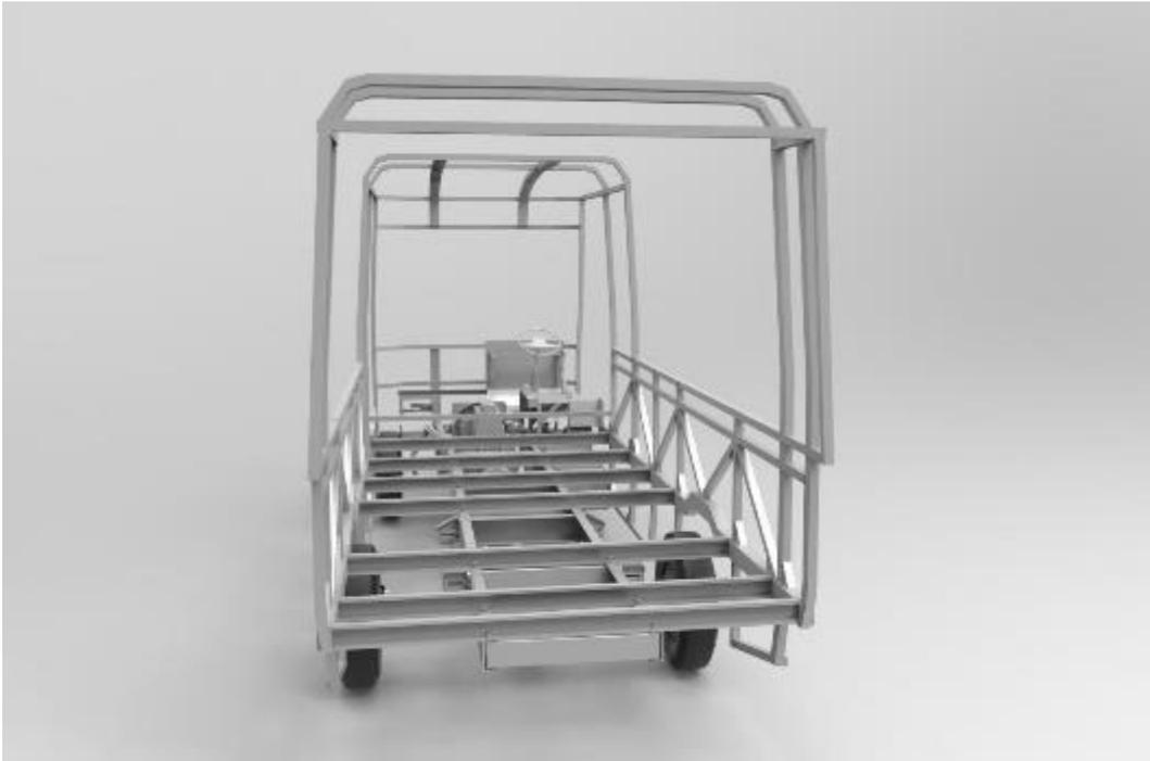
*Gambar 5. 17 Pemasangan Rangka Pada Sasis Utama Kendaraan (penulis,2019)*
