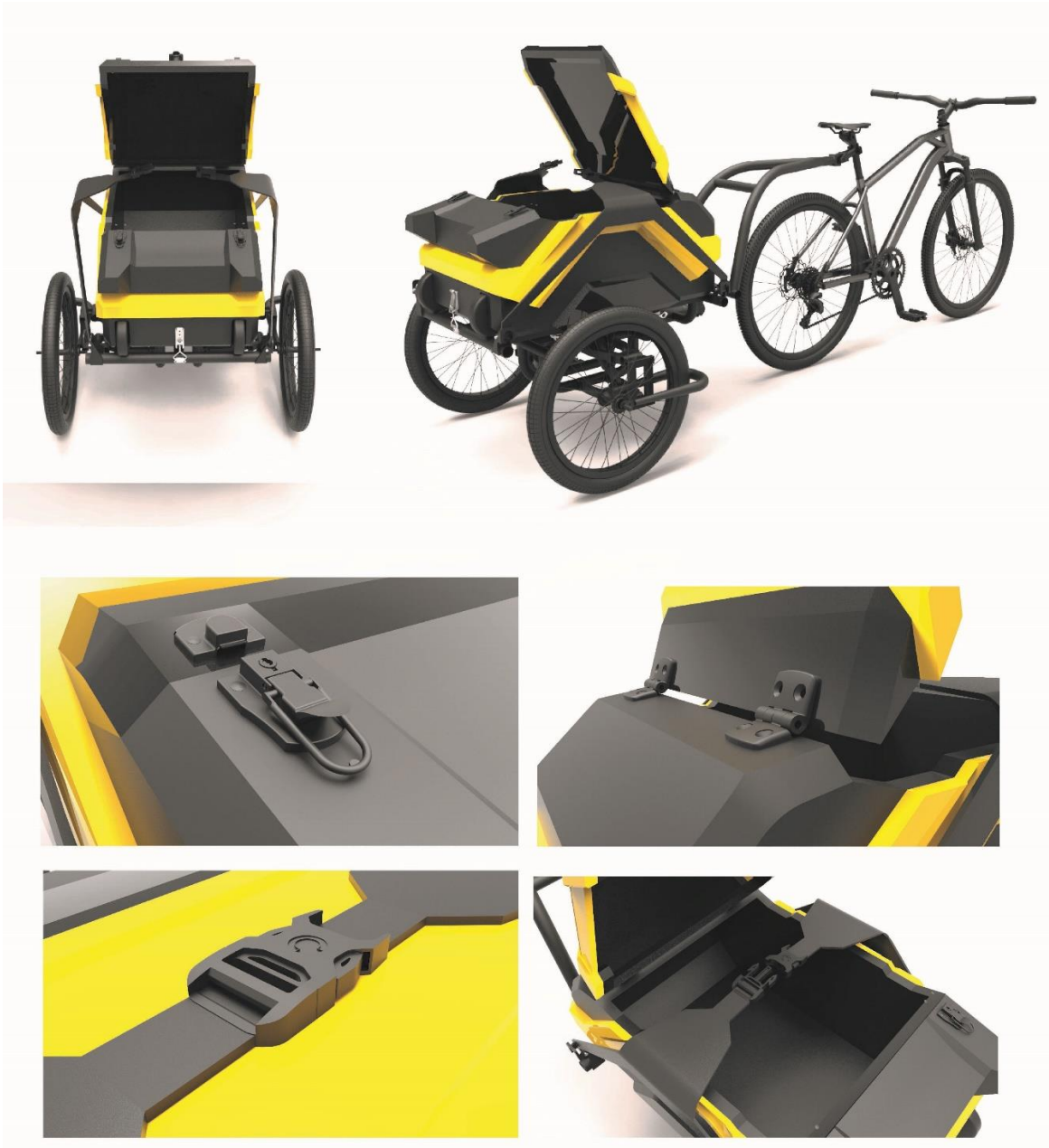
Gambar 4. 8 Mekanisme buka-tutup box
