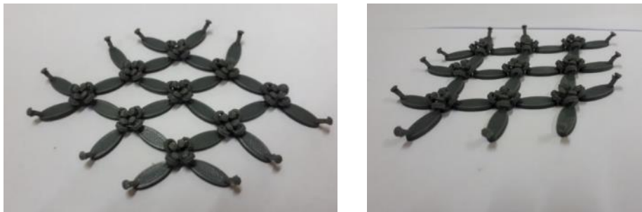
Gambar 4.12 Foto Dokumentasi hasil 3D Print, Material PLA
