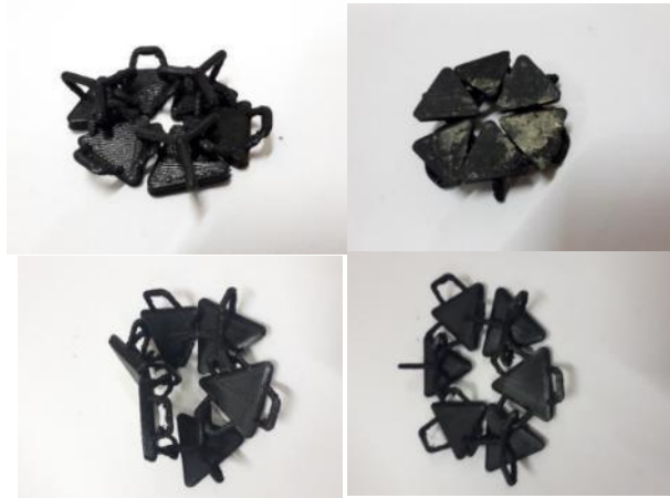
Gambar 4.23 Dokumentasi hasil cetak 3D pada model chainmail fabric.
