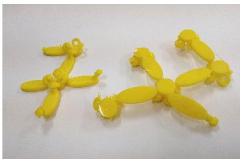
Gambar 4.13 Foto Dokumentasi hasil 3D print, Material ABS
