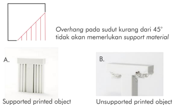
Gambar 2.1 Overhangs pada FFF printer
