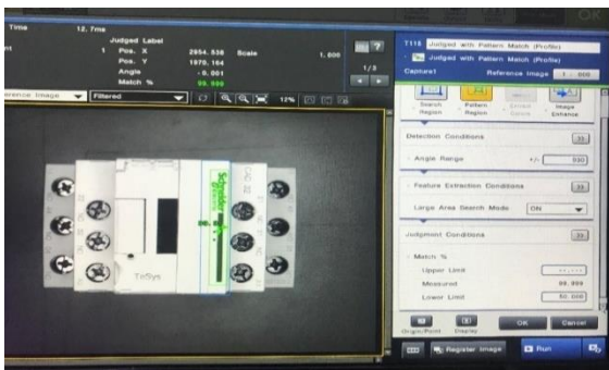
Gambar 4.12 Penggunaan Tools Pattern Match (Profil) Pada Produk
