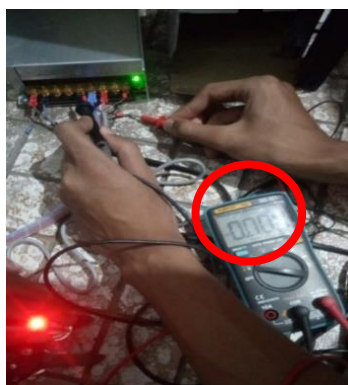
Gambar 4.9 Pengujian Sensor Proximity Induktif Terkena Benda Logam
