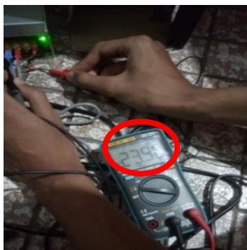
Gambar 4.8 Pengujian Sensor Proximity Induktif Ketika Tidak Terkena Benda Logam
