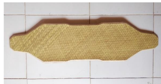
Papan Longboard Laminasi Daun Lontar
