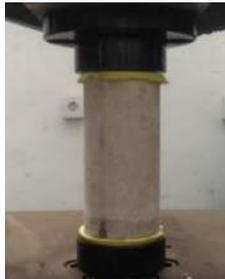
**Gambar 2.3** Set up pengujian kuat tekan
