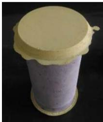
**Gambar 3.6** Benda uji yang dilapisi belerang
