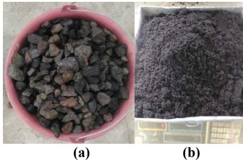
**Gambar 3.3** Agregat (a) kasar (batu pecah) (b) halus ( pasir)
