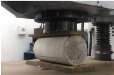
**Gambar 2.4** *Set up* kuat tarik belah beton
