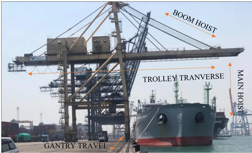
Gambar 3. 8 Istilah pergerakan / mekanisme pada CC (Lokasi: JICT, Jakarta)
