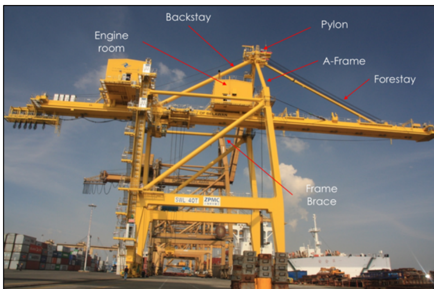
Gambar 3. 7 Bagian-bagian CC, Lokasi: Shanghai, China (ii) (Sumber: www.pelindo1.co.id )
