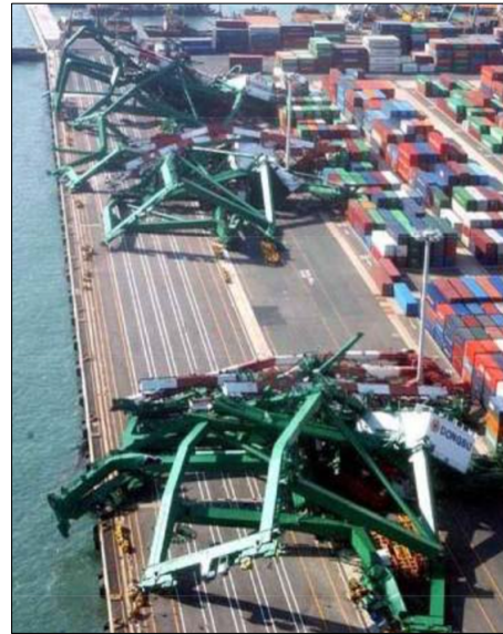
Gambar 4. 6 Crane Deformasi & Rubuh di Jepang akibat Gempa Bumi (Sumber: www.liftech.net )
