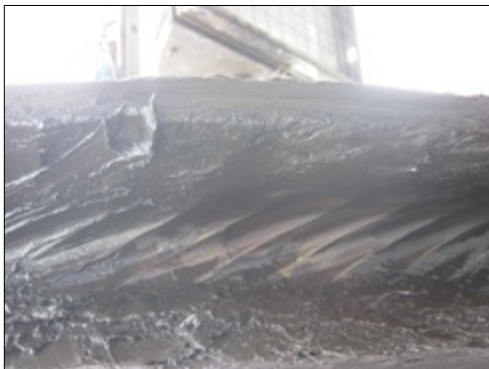
Gambar 4. 2 Imprinting (tergerus) pada Pulley
