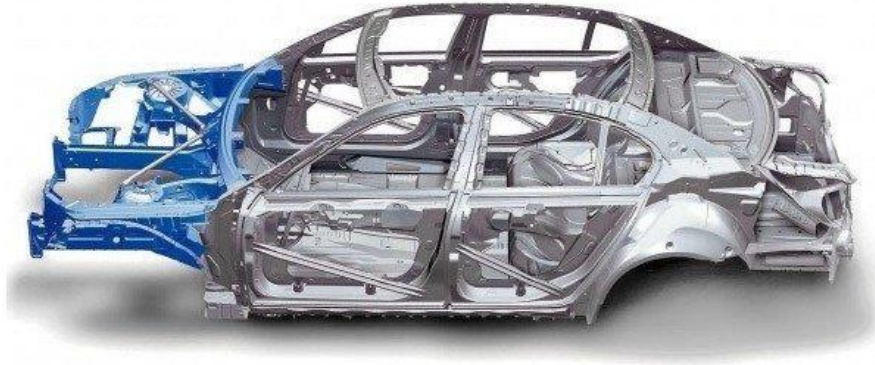
Gambar 4. 24 Monocoque Chassis (otomotif.kompas.com)
