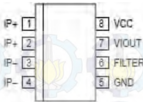
Gambar 2.8. Konfigurasi Pin Sensor Arus ACS712
