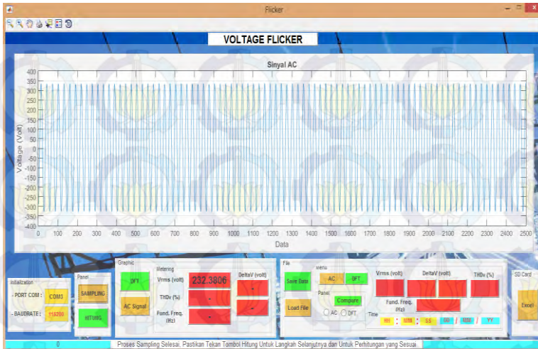
Gambar 4.23. Tampilan Gelombang Tegangan Hasil Sampling pada Software MATLAB
