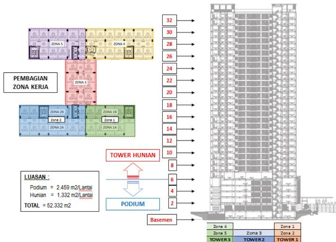
Gambar 4.2. Potongan Gambar Pekerjaan Basement – lantai 33
