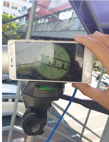
Gambar 3.10: Pengukuran sudut kemiringan kamera
