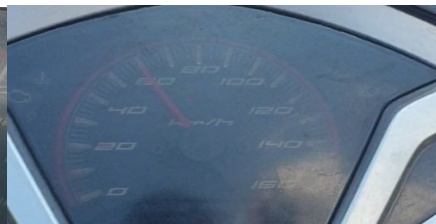
Gambar 4: Perekaman spidometer 60km/h pada sepeda motor untuk uji akurasi kecepatan
