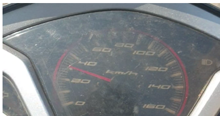
Gambar 2: Perekaman spidometer 30km/h pada sepeda motor untuk uji akurasi kecepatan
