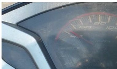
Gambar 3: Perekaman spidometer 40km/h pada sepeda motor untuk uji akurasi kecepatan
