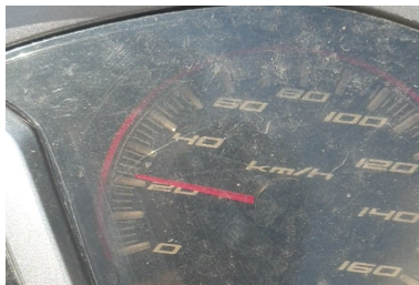
Gambar 1: Perekaman spidometer 20km/h pada sepeda motor untuk uji akurasi kecepatan
