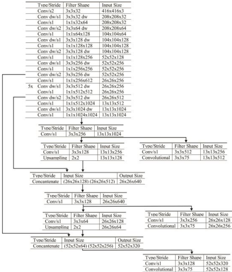
Gambar 3.7: Arsitektur deteksi objek YOLO modifikasi dengan Feature Extractor Mobilenet
