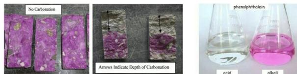
**Gambar 4.42** Indikator Karbonasi Pada Beton
