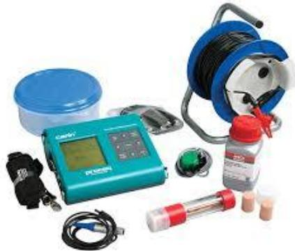
**Gambar 4.13.** PROCEQ CANIN + Instrumen Penganalisis Korosi.
