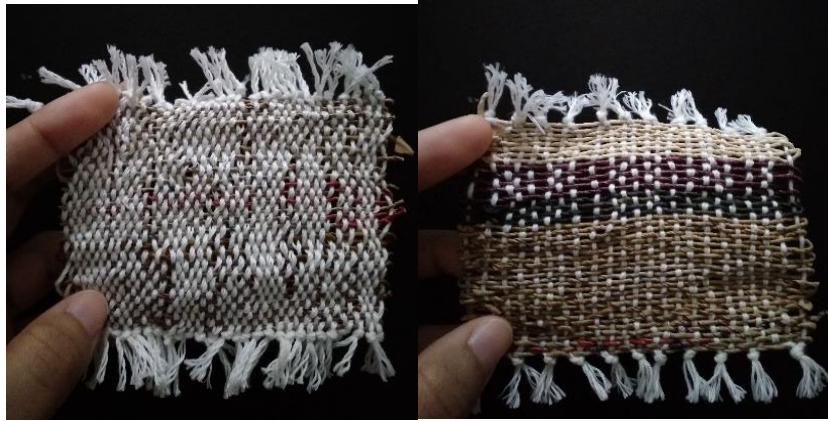
Gambar 4.36 anyaman pada pilinan kertas semen menggunakan benang kasur dengan kerapatan yang berbeda (Sumber: penulis)
