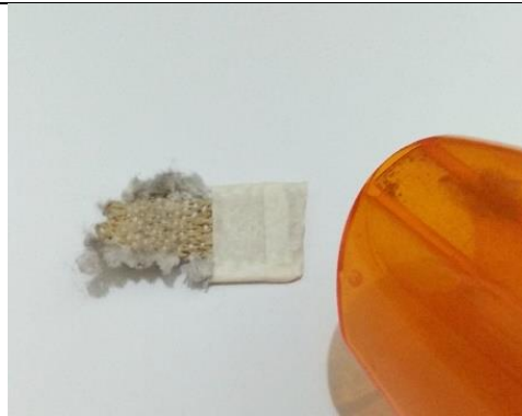
Gambar 4.51 Percobaan perawatan dengan vakum (Sumber: Penulis)
