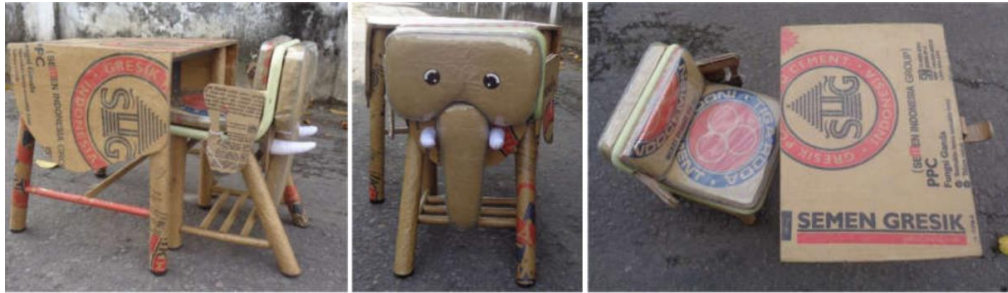
Gambar 1 Pengembangan Desain Furnitur Anak Berbahan Kertas Semen Bekas dengan Teknik Laminasi & Spiral Wound Tubing (Oentoro, Kristian. 2016)
