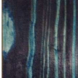
Gambar 4. 12. Hasil percobaan pewarnaan dengan diampelas hingga permukaan kayu rata, pewarna tekstil biru dan wax kayu. (Sumber: Penulis, 2018)
