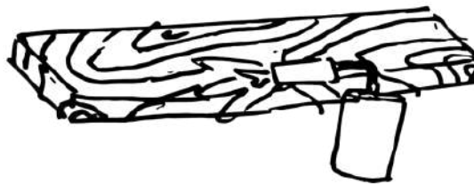
Gambar 2. 4. Pembakaran dengan menggunakan obor gas Sumber: Penulis, 2019
