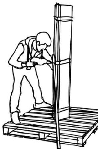
Gambar 2. 3. Mengeratkan ikatan antar kayu agar tidak aman saat dibakar Sumber: Penulis, 201
