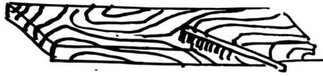
Gambar 2. 5. Tahap Penyikatan dengan sikat kawat Sumber: Penulis, 2019
