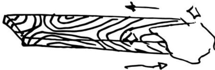
Gambar 2. 6. Pengelapan dengan kain bersih Sumber: Penulis, 2019
