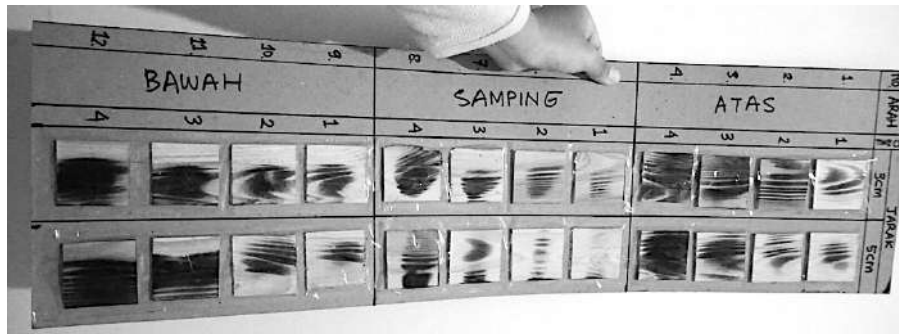
Gambar 4. 6. Percobaan dengan menggunakan Kayu Pinus Belanda dengan arah pembakaran dari bawah, samping dan atas dan atas selama 1 - 4 detik dan jarak antara obor ke kayu 3cm dan 5cm (Sumber: Penulis, 2018)
