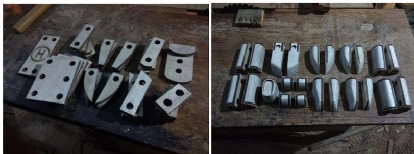
Gambar 5.33 Modul yang dibuat dengan metode *laser cutting*
