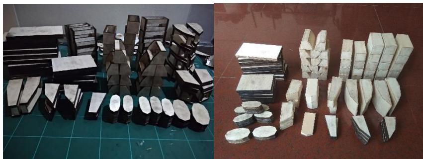
Gambar 4.19 Prototype modul dengan metode *laser cutting*
