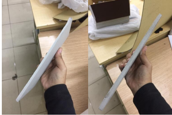
Gambar 6. 4 Uji ketebalan pada concreet (kiri) ketebalan 5m dan (kanan) ketebalan 7mm (sumber : Penulis 2019)
