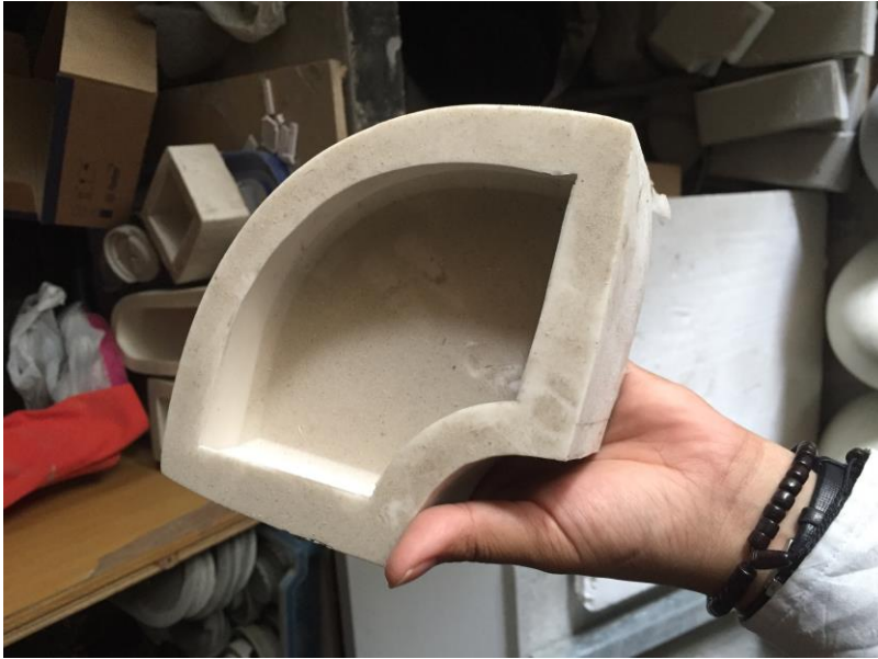
Cetakan home decor di studio Conture Indonesia menggunakan silicon rubber
