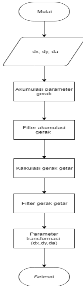
Gambar 3.30 Diagram alir metode kompensasi gerak dengan SPLF (IIR)
