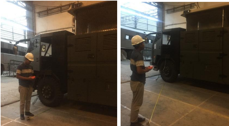
Gambar 4.5 Pengujian remote kabel dengan jarak 1 meter dan 3 meter
