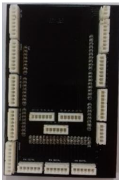
Gambar 3.9 Hasil board beserta socket jst-xh tampak atas
