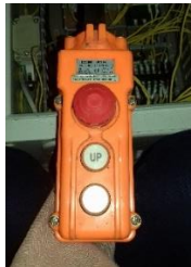
Gambar 4.7 Remote kabel hidrolik
