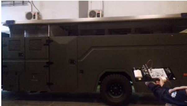
Gambar 4.2 Pengujian kerja remote dengan kendaraan Ganila 2.0
