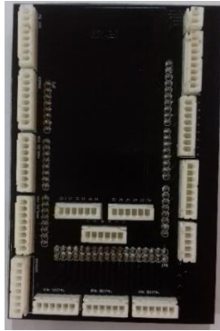
Gambar 3.9 Hasil board beserta socket jst-xh tampak atas
