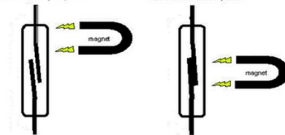
Gambar 2. 28 Prinsip Kerja Reed Switch
