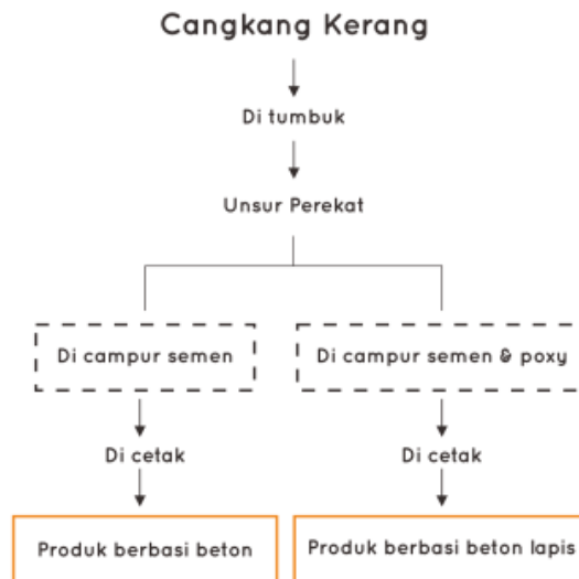
Gambar 4 8: Skema Pembuatan Produk Berbahan Cangkang Kerang Sumber : Penulis (2018)
