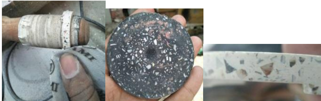
Gambar 4 12: Pengamplasan Beton Cangkang Kerang Sumber : Penulis (2018)
