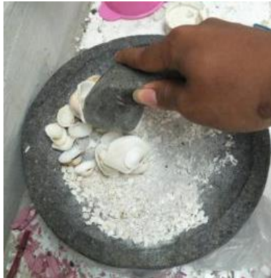
Gambar 4 10 : Penumbukan Cangkang Kerang Sumber : Penulis (2018)
