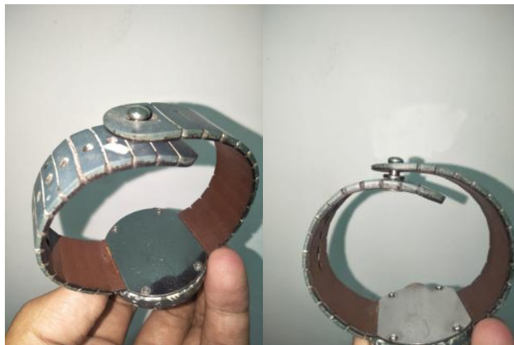
Gambar 4 16 Penerapan Buckle pada Prototype Sumber : Penulis (2018)
