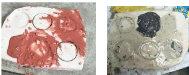
Gambar 4 11: Pengecoran Beton Cangkang Kerang Sumber : Penulis (2018)
