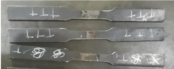
Gambar 3.8 Spesimen Uji Tarik Arah Vertikal
