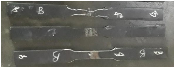
Gambar 3.9 Spesimen Uji Tarik Arah Horizontal
