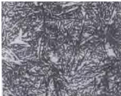
Gambar 2. 15 Struktur Mikro Martensit
