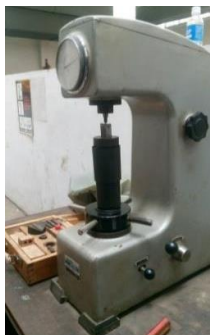
Gambar 3.10 Alat Uji Kekerasan Rockwell
