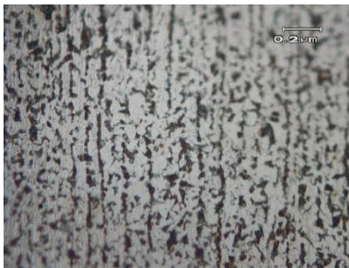
Gambar 4. 6 Struktur Mikro Base Metal pada Variasi Horizontal
