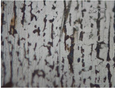
Gambar 4. 5 Struktur Mikro HAZ pada Variasi Horizontal
