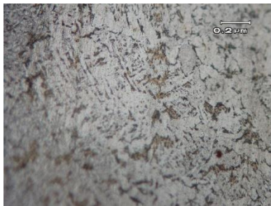
Gambar 4. 7 Struktur Mikro Weld Metal pada Variasi Vertical
