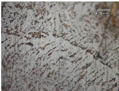
Gambar 4.4 Struktur Mikro Weld Metal pada Variasi Horizontal
