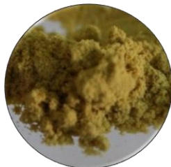
Gambar IV.6 Foto Hasil Sintesis pada 2V, pH 3, dengan rasio \text{Fe}^{3+} : \text{Fe}^{2+} sebesar 1:1
