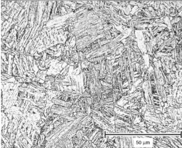
Gambar 2. 19 Struktur mikro bainit dari baja paduan rendah yang telah mengalami perlakuan panas ( ASM International 2004 )
