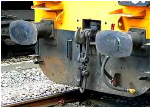
Gambar 2. 1 Screw Coupler pada Kereta Api
