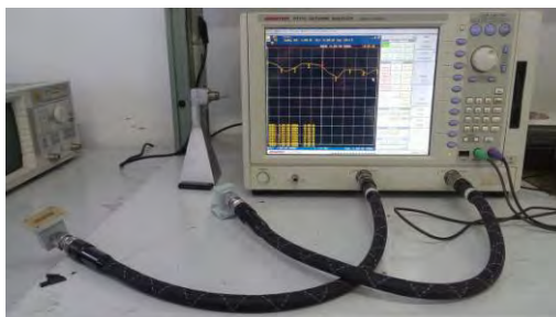
Gambar 3.4 Peralatan Uji VNA
