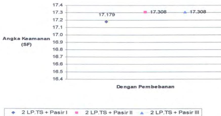
**Gambar 4.21** Perbandingan Angka Keamanan Dengan Bahan Komposit (*Tyresoil* dan pasir) dengan variasi jarak pembebanan vertikal.
