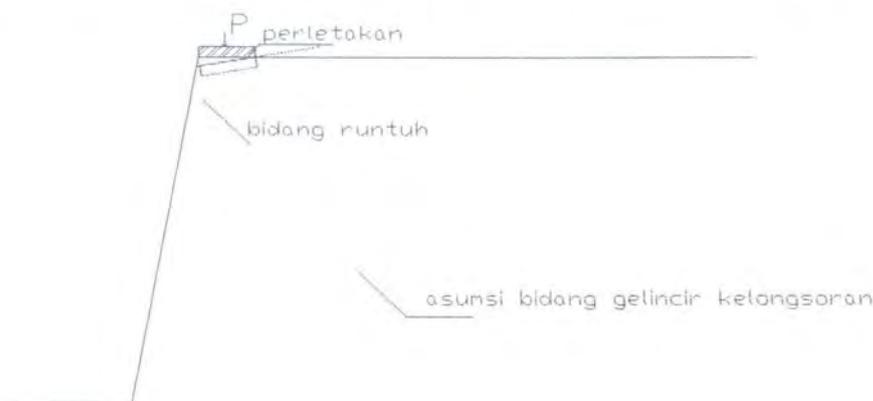
**Gambar 4.26** Mekanisme keruntuhan tanpa *tyresoil* simulasi model I Manual
