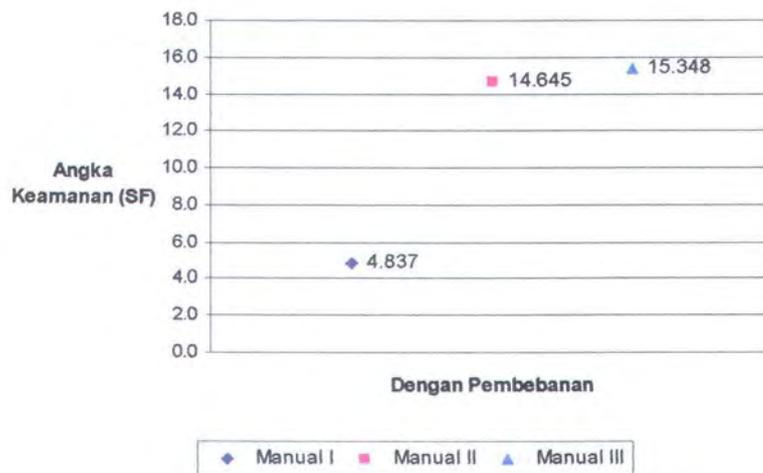
**Gambar 4.20** Perbandingan Angka Keamanan Tanpa *Tyresoil* dengan variasi jarak pembebanan vertikal
