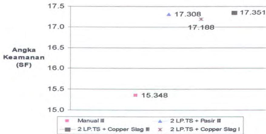
**Gambar 4.25** Perbandingan Angka Keamanan Tanpa *Tyresoil* dan Dengan Bahan Komposit (*tyresoil* dan pasir maupun *tyresoil* dan *copper slag*) pada Simulasi Model Lereng III dengan pembebanan vertikal
