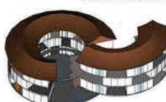
pada zona inap ,struktur menggunakan sistem struktur Box , sehingga memungkinkan terdapat celah diantara tiap unit untuk memasukan udara sehingga tidak tersa berjajal dan sirkulasi udara dapat mengalir dengan baik
