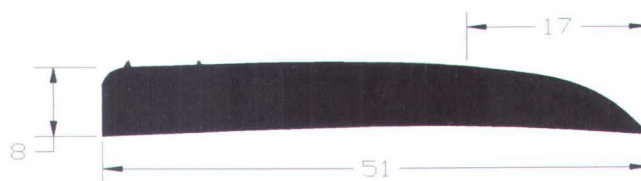
Gambar 4.4 Sirip bagian bawah Adji Prop X.1.2
