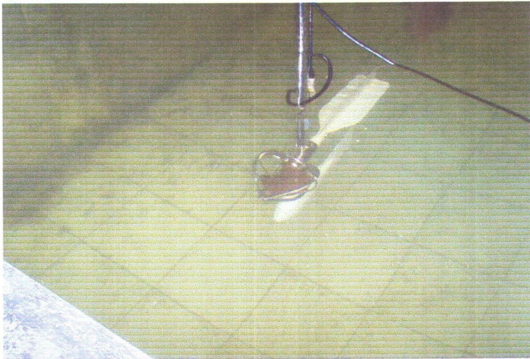
Gambar A. 19 Posisi current meter di depan propeler
